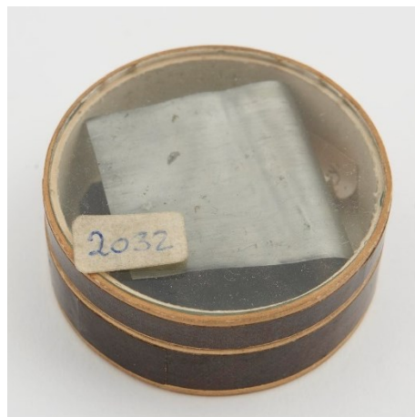
Rysunek 7. Eksponat muzealny – miedziana blaszka z osadzoną elektrolitycznie warstwą palladu (Muzeum Nauki w Londynie, nr eksponatu 1889-164/2032) [62].
