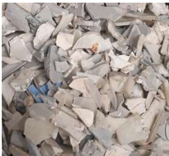
Rys 1. Mieszanka tworzyw sztucznych (głównie PP i ABS) otrzymywana ze sprzętu AGD
