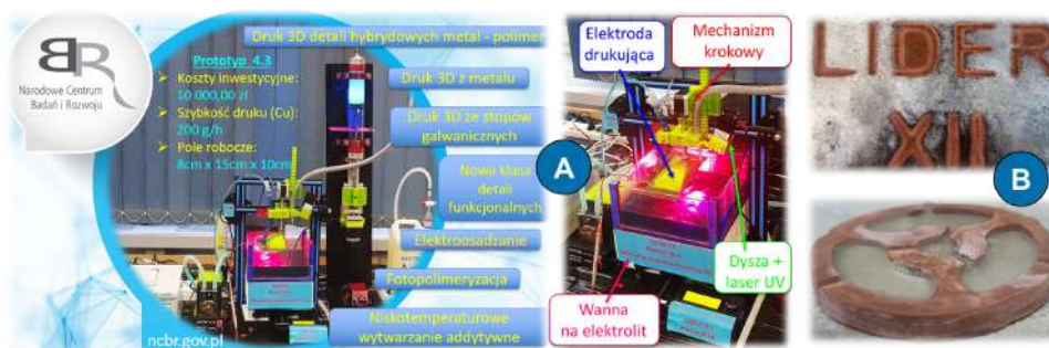
Rys.1. A - Zdjęcie przedstawiające innowacyjną drukarkę 3D do druku detali hybrydowych typu metal-tworzywo sztuczne. B – Zdjęcia pierwszych wydruków z nowej drukarki 3D.
