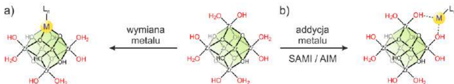
Rysunek 16. Schematyczne przedstawienie post-syntetycznych modyfikacji węzłów cyrkonowych polegające na a) wymianie metalu tworzącego węzeł lub b) addycji (koordynacji) kationu metalu do grup hydroksylowych Zr-węzła; stosowane oznaczenia: M – wprowadzany kation metalu, L_n – n ligandów skoordynowanych do metalu
