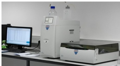
Rysunek 6. Izokratyczna chromatografia jonowa z detektorem konduktometrycznym [chromatograf jonowy ICS-1100 (Thermo Scientific)], mierzono jony: \text{Na}^+ , \text{NH}_4^+ , \text{K}^+ , \text{Mg}^{2+} , \text{Ca}^{2+} , \text{F}^- , \text{Cl}^- , \text{NO}_2^- , \text{NO}_3^- , \text{PO}_4^{3-} , \text{SO}_4^{2-} .
