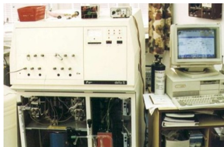
Rysunek 9. Spektrometria masowa stosunków izotopowych (IRMS) (spektrometr masowy Finnigan Delta-S), analiza próbek pod kątem zawartości izotopu \delta^{13}\text{C} w ich frakcji węglowej.
