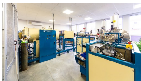
Rysunek 10. Akceleracyjna spektrometria mas (AMS) (spektrometr „Compact Carbon AMS”) do analizy zawartości ^{14}\text{C} w próbkach (źródło: www.radiocarbon.pl ).
