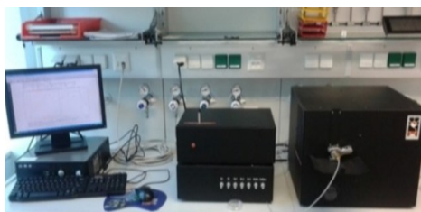
Rysunek 5. Termo-optyczna analiza OC/EC (analizator OC/EC Sunset Laboratory Inc. – do określania zawartości węgla organicznego i elementarnego).
