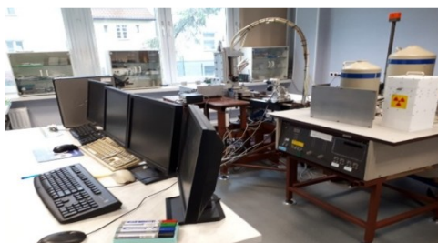
Rysunek 8. Spektrometria fluorescencji rentgenowskiej z dyspersją energii (EDXRF) (aparat zaprojektowany przez pracowników WFiIS AGH), badano zawartość następujących pierwiastków w próbkach: Cl, K, Ca, Ti, V, Cr, Mn, Fe, Co, Ni, Cu, Zn, Br, Rb, Sr, As, Pb.
