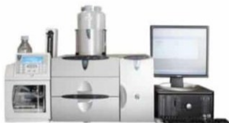
Rysunek 7. Wysokosprawna chromatografia anionowymienna z pulsacyjnym detektorem amperometrycznym (Dionex ICS 3000), mierzono zawartość 14 związków organicznych, w tym lewogłukozy.
