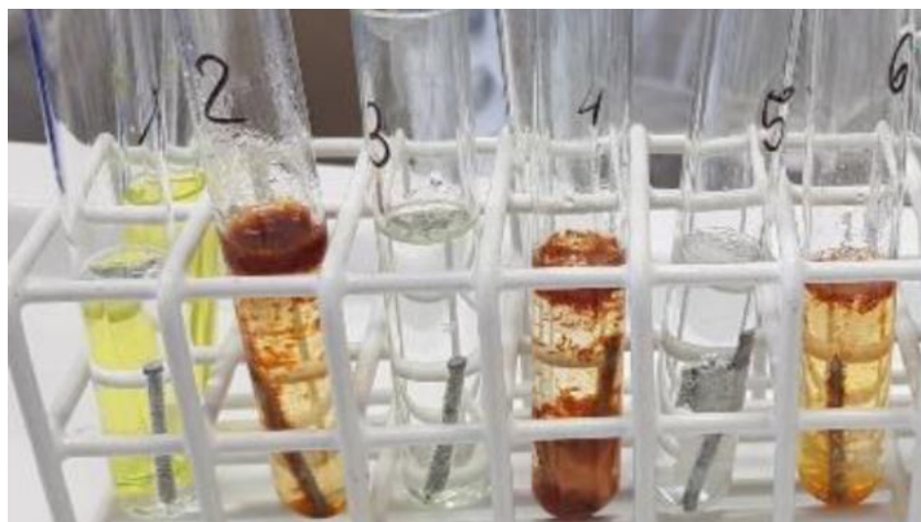
Rys. 1. Wpływ różnych czynników na korozję żelaza [slajd z prezentacji].
