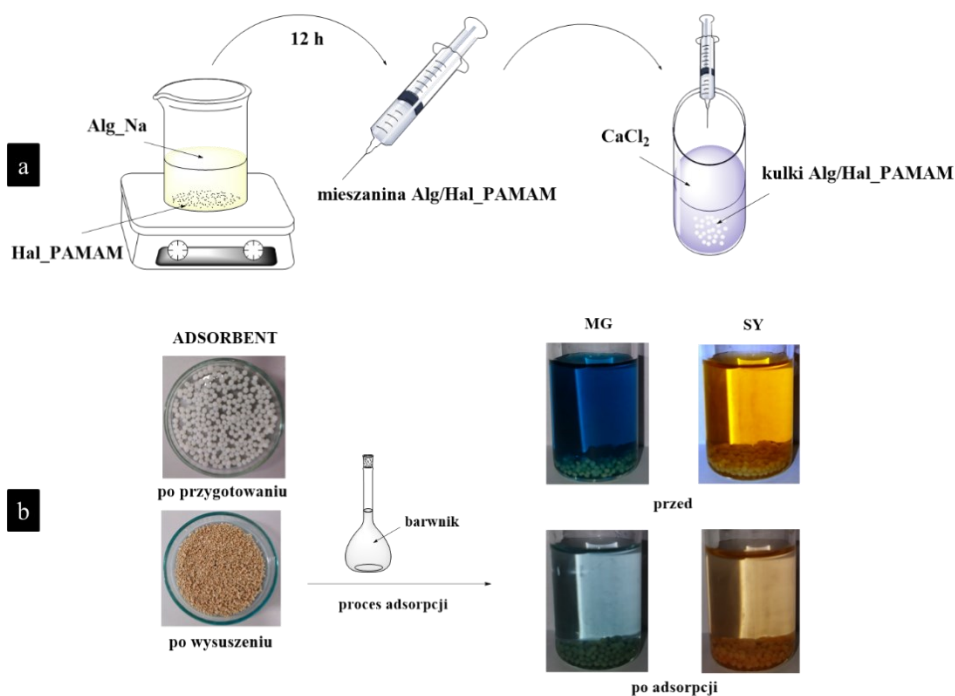
Rysunek 6. Schemat otrzymywania kulek alginianowych z haloizytem (a) oraz ich zastosowanie do adsorpcji barwników (b)
