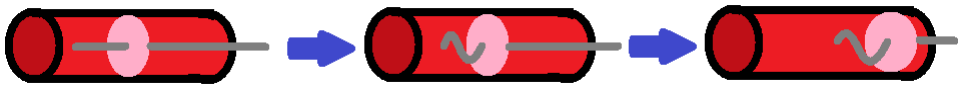
Rysunek 7. Schemat usuwania skrzepu w naczyniu krwionośnym za pomocą aktywowanego laserem mikrośiłownika polimerowego z pamięcią kształtu sprzężonego ze światłowodem Figure 7. Diagram of the removal of a clot in a blood vessel using a laser-activated polymer micromotor with a shape memory coupled with an optical fiber
