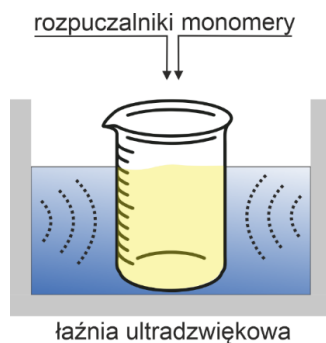
Rysunek 3. Schemat syntezy COF metodą sonochemiczną
