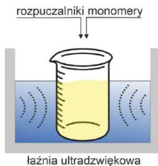
Rysunek 3. Schemat syntezy COF metodą sonochemiczną
