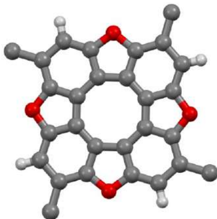
Rysunek 15. Przykład płaskiej struktury molekularnej złożonej z czterech pierścieni furanowych i czterech pierścieni sześciocłonowych (z alkilowych C4 podstawników pokazano tylko pierwsze atomy węgla)
