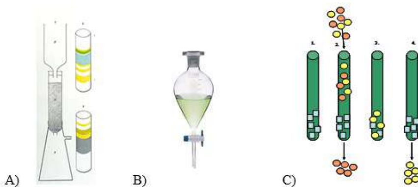
Rys. 9. Zasada chromatografii wg. idei M.S. Cwieta A – przykładowe rozdzielanie mieszaniny chlorofilu i chloroplastów; B – zasada ekstrakcji ciecz-ciecz; C – ekstrakcji ciecz-ciało stałe (SPE)
