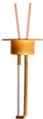
Rysunek 2. Pierwszy (1972 r.) polski filament detektora termoprzewodnictwa (tzw. katarometru) do chromatografii gazowej wyprodukowany w Zakładzie Chemii Fizycznej UMCS w Lublinie. Figure 2. The first (1972) Polish filament of a thermal conductivity detector (so-called catharometer) for gas chromatography produced at the Department of Physical Chemistry of Maria Curie-Skłodowska University in Lublin.
