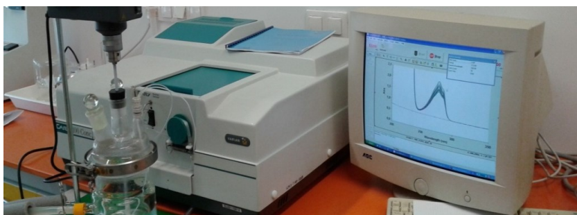
Rysunek 1. Zestaw pomiarowy do badania kinetyki adsorpcji z roztworów przy użyciu spektrofotometru Cary 100, Varian z celą przepływową.
