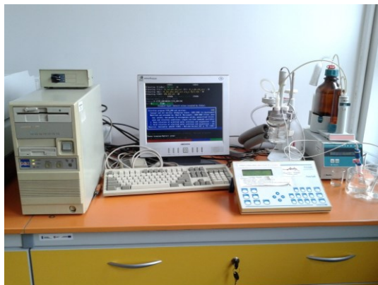
Rysunek 3. Zestaw do miareczkowania potencjometrycznego: autobiureta (Dosimat 765), pehametr (PHM240, Metrohm, Radiometer), oprogramowanie własne.
