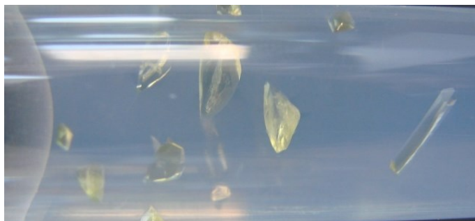
Rysunek 3. Kryształy cytrynianu kadmu w żelu krzemionkowym. Figure 3. Cadmium citrate crystals in silica gel.
