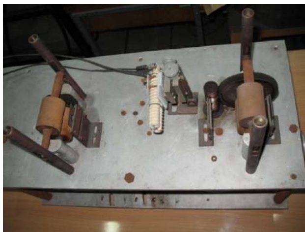
Rysunek 3. Pierwsza (1972 r.) skonstruowana w Zakładzie Chemii Fizycznej UMCS w Lublinie wyciągarka do kolumn kapilarnych – prymitywny protoplasta wyciągarek do produkcji polskich światłowodów.
