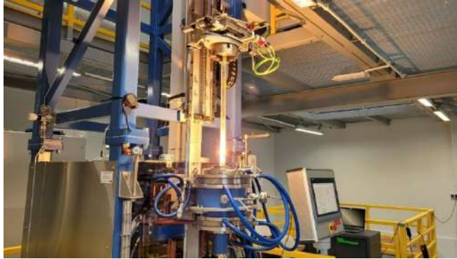
Rysunek 9. Pracująca wyciągarka do światłowodów na Hali Póltechniki po modernizacji.
