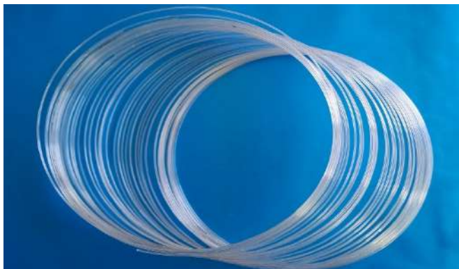
Rysunek 4. Pierwsze (1975 r.) polskie szklane kolumny kapilarnie do chromatografii gazowej wyprodukowane w Zakładzie Chemii Fizycznej UMCS w Lublinie.
