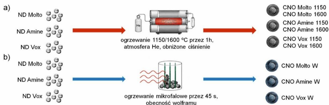
Rys. 1. Porównanie otrzymywania CNOs: a) metoda Kuznetzowa; b) synteza mikrofalowa wspomagana wolframem.
