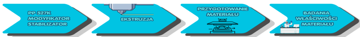
Rys.1. Uproszczony schemat procesu otrzymywania i charakterystyki mieszanin polipropylenu PP 527K z dodatkiem modyfikatorów i stabilizatora.
